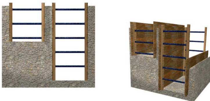
Figura 2 - Esempio di posizionamento di armatura in fasi parziali e successive di scavo
